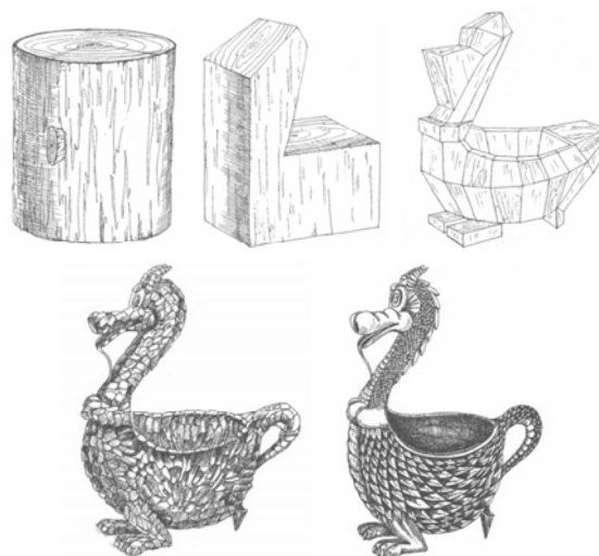
Рисунок 4. Этапы изготовления ковша
